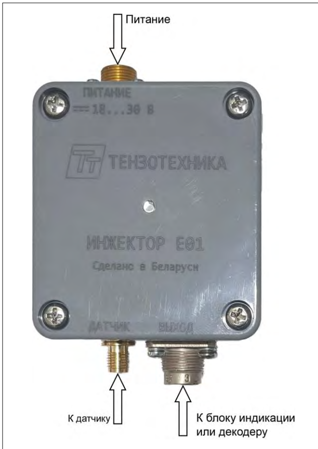
Рис. 7 – Инжектор E01(слева) и кабель «2» для подключения декодера к инжектору (справа)
